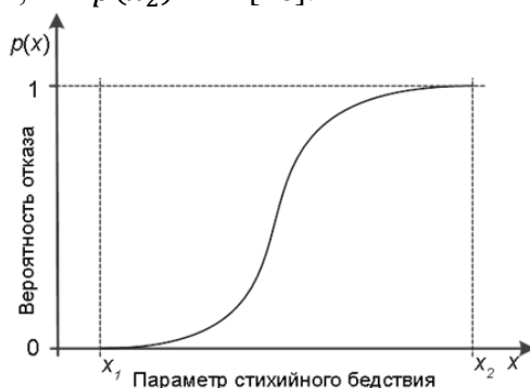
Рис. 5. Типовой график уязвимости компоненты микросети
