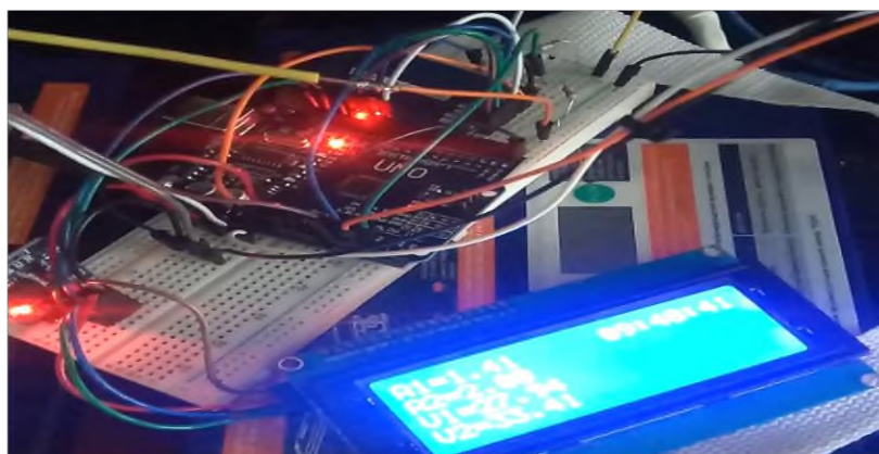
Рис. 3. Счетчик на основе микроконтроллера Arduino и шунтового амперметра.
