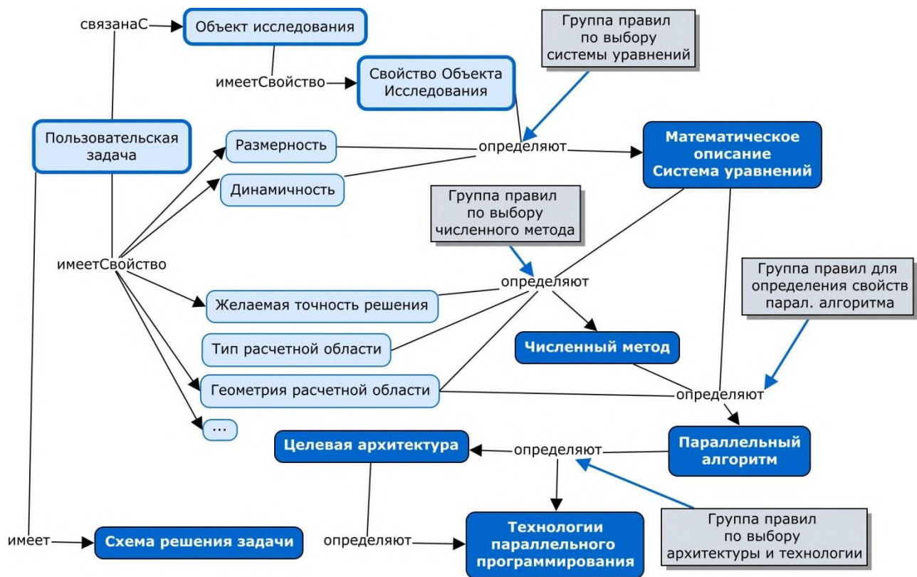
Рис. 2. Схема взаимосвязей между основными блоками пользовательского интерфейса, элементами схемы решения задачи и группами правил.
