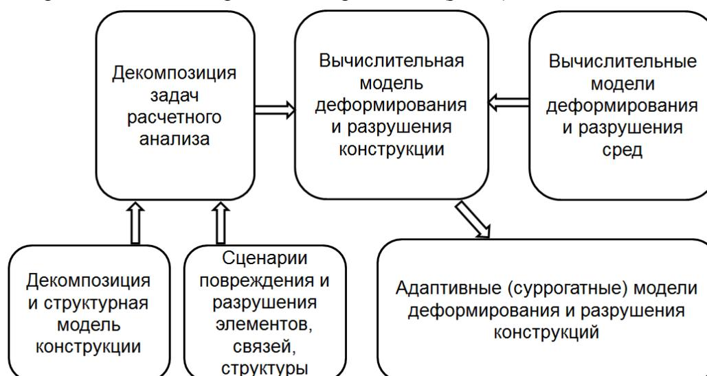
**Рис. 1.** Структура информационно-вычислительной метамодели деформирования и разрушения структурно-сложной конструкции
