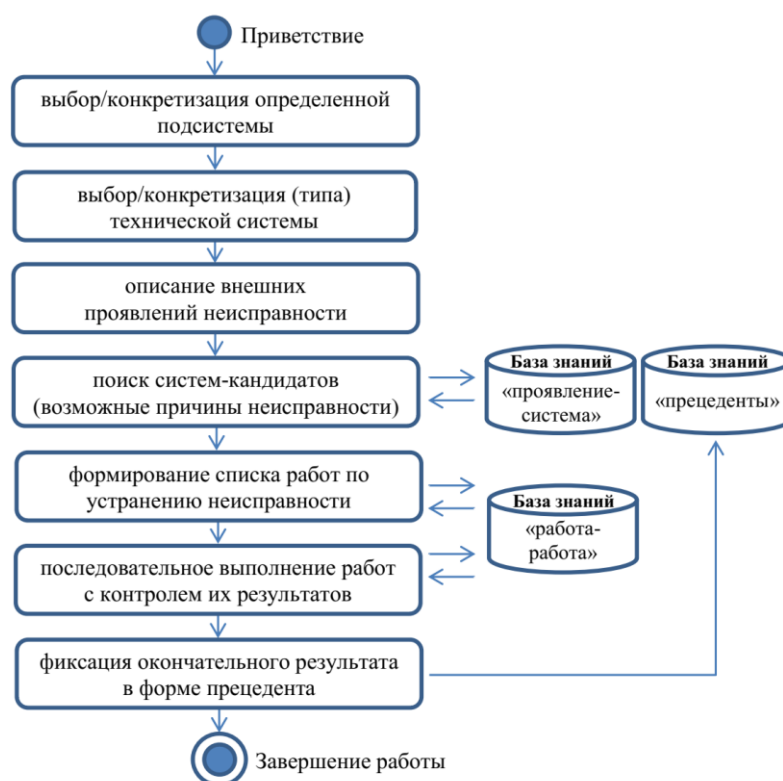
Рис. 1. Обобщенный алгоритм диагностирования
