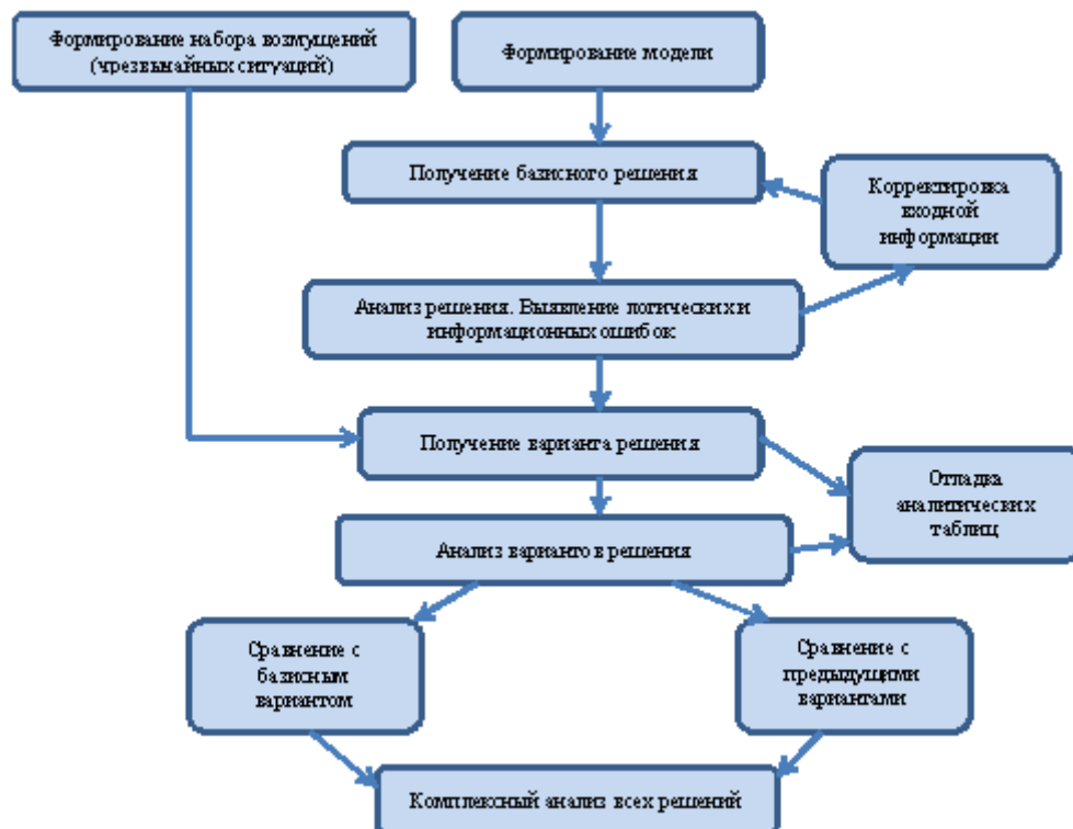
Рис. 8. Блок-схема последовательности работы с моделью и ПК ИНТЭК-SAW
