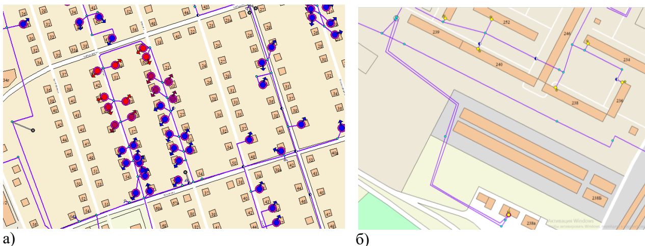
Рис. 6. Типичные схемы размещения потребителей с нарушением качества воды: а) в конце длинных улиц; б) при двухтрубной схеме подключения
