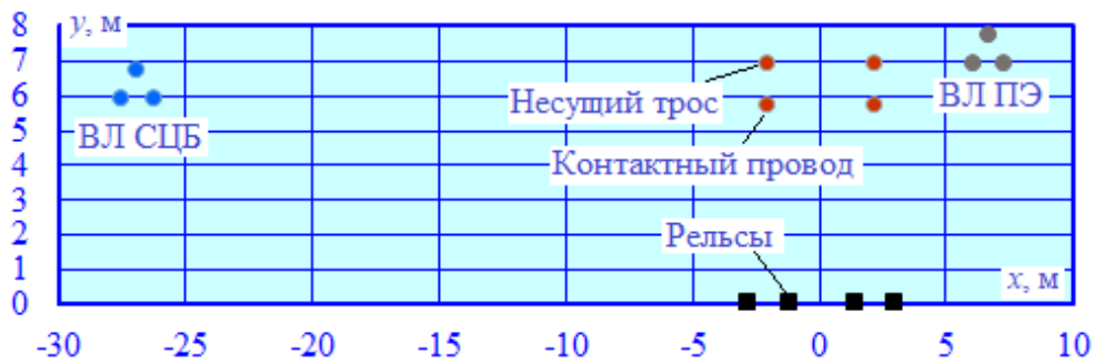
Рис. 3. Расположение токоведущих частей
