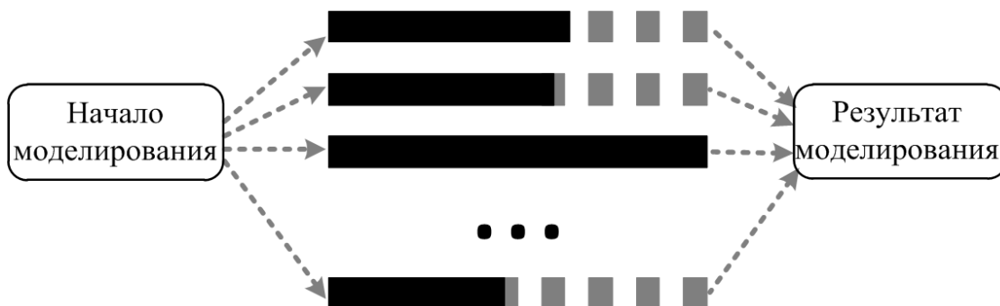
Рис. 1. Распараллеливание вычислений при схемотехническом моделировании по методу Монте-Карло.
