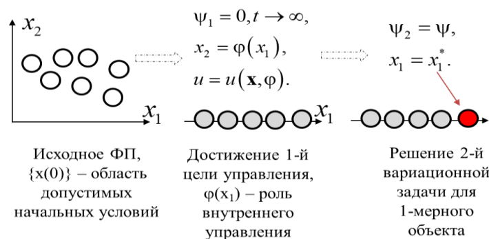
Рис. 1. Последовательное решение двух вариационных задач обеспечивает достижение цели управления (для модели 2-го порядка); ФП – фазовое пространство
