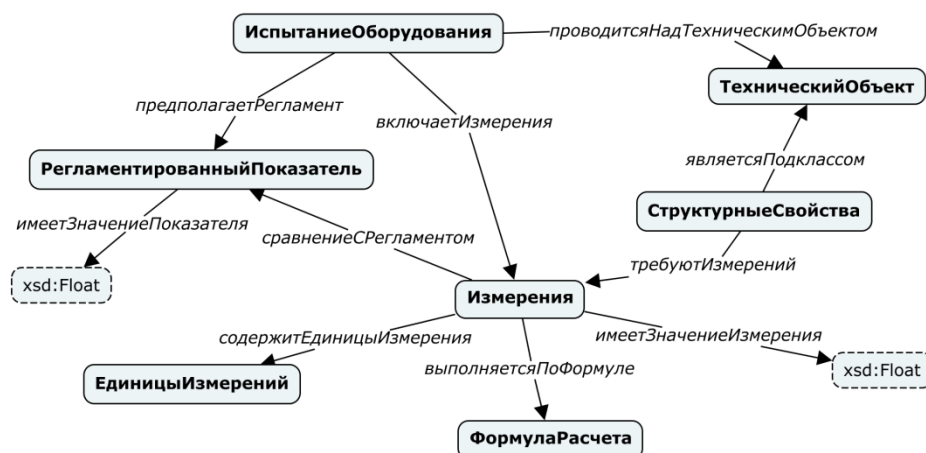
Рис. 3. Фрагмент онтологической схемы, описывающий процесс измерения
