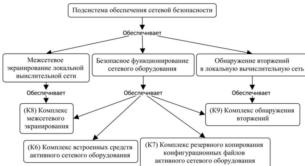
**Рис. 10.** Онтология подсистемы обеспечения сетевой безопасности
