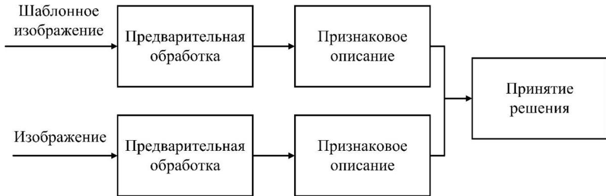
**Рис. 1.** Структура системы обнаружения объектов
