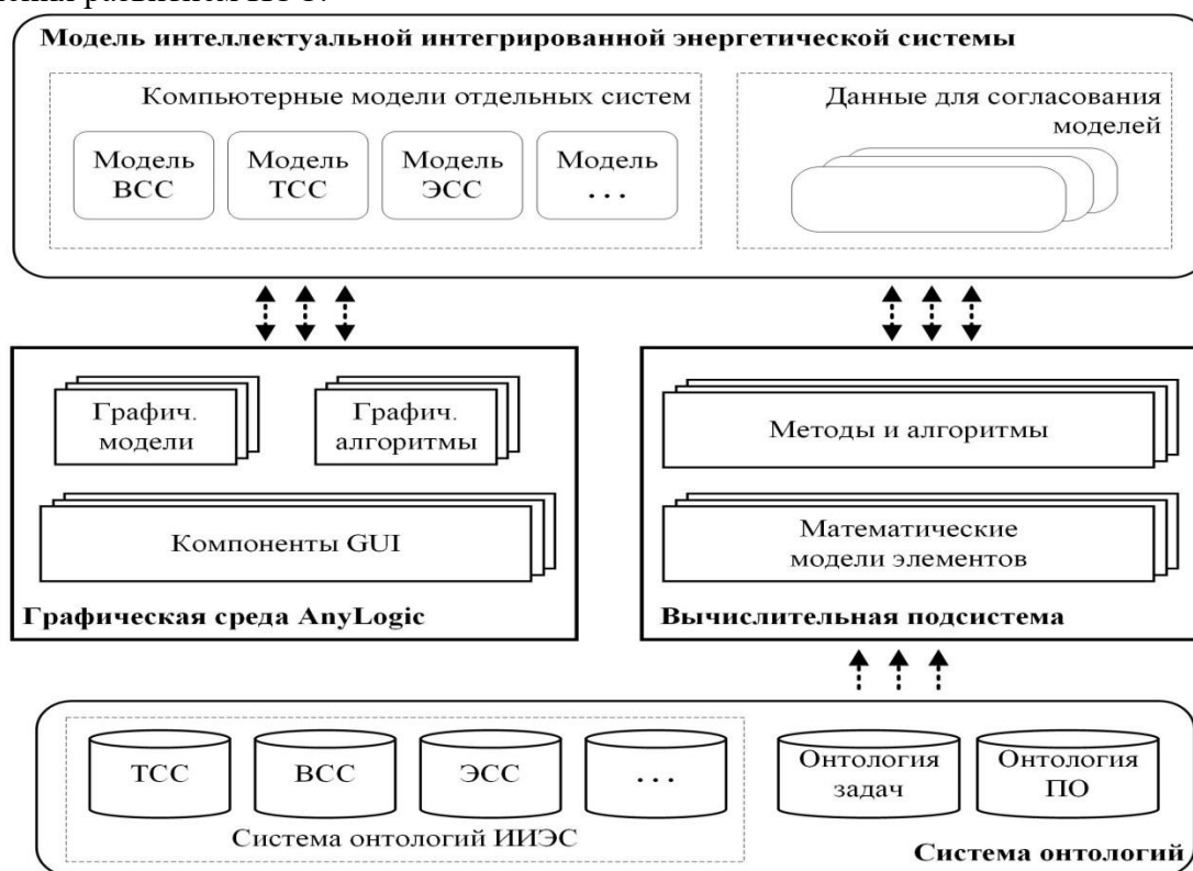
Рис. 1. Архитектура программной платформы для управления развитием интегрированных энергетических систем: ВСС – водоснабжающая система; ТСС – теплоснабжающая система; ЭСС – электроснабжающая система
