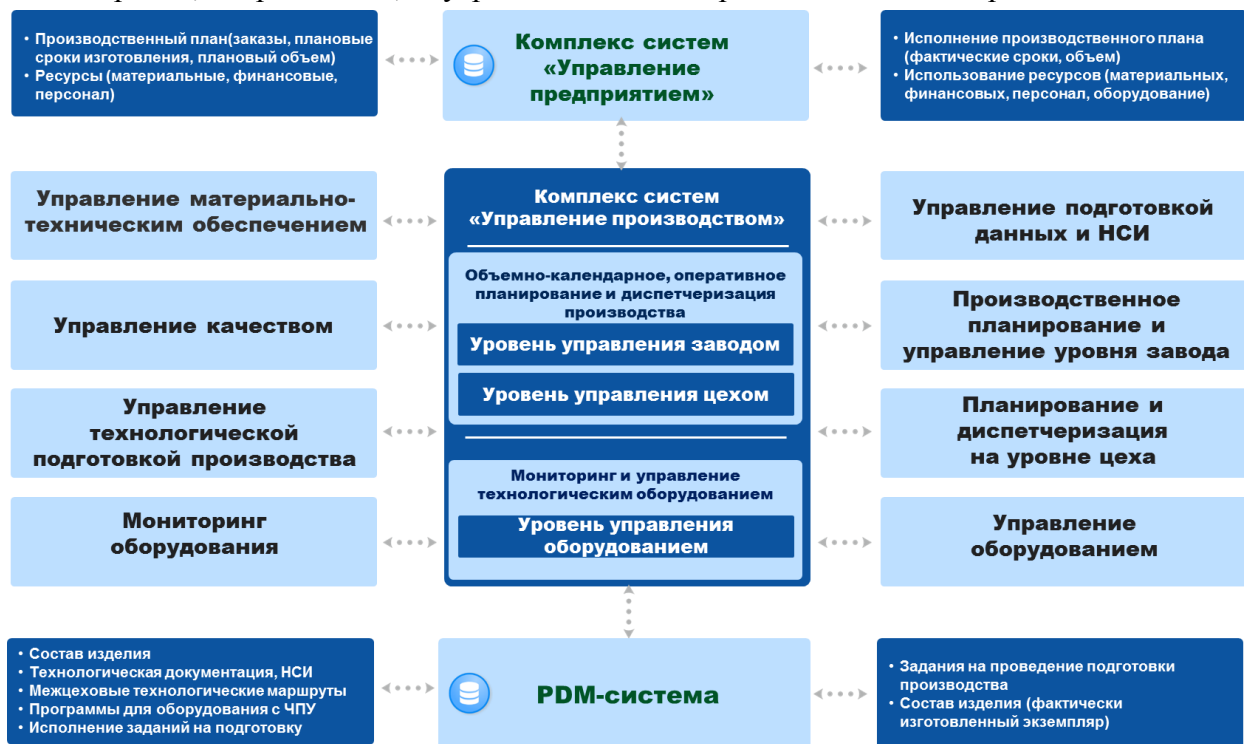
Рис. 1. Система управления производством в составе сквозной технологии
